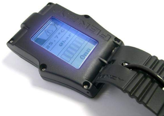
Fotografia nr 4.7. Bezprzewodowy zintegrowany czujnik kontrolny
