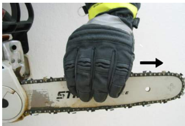
Fotografia nr 5.5. Sprawdzanie płynności ruchu łańcucha tnącego
