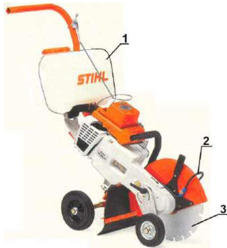
Fotografia nr 5.9. Widok piły ze zbiornikiem wody 1. Zbiornik wody zamontowany na ramie nośnej piły 2. Przewód doprowadzający wodę do tarczy tnącej 3. Tarcza tnąca „diamentowa”
