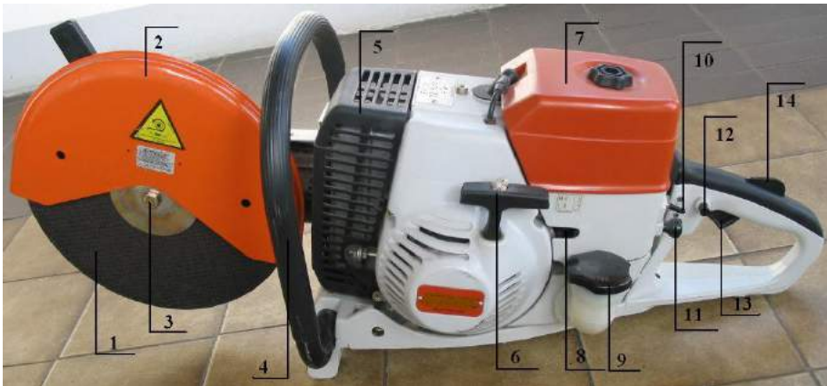
Fotografia nr 5.6. Budowa piły tarczowej
