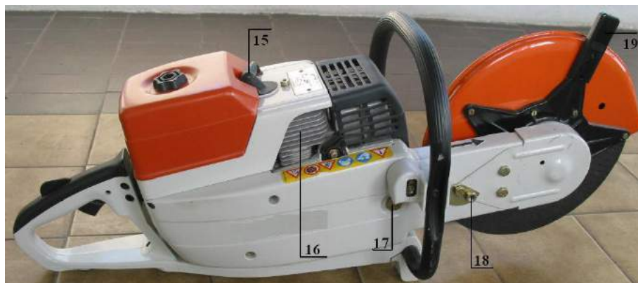
Fotografia nr 5.7. Budowa piły tarczowej c.d.
