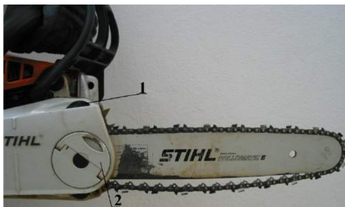
Fotografia nr 5.3. Niewłaściwe napięcie łańcucha tnącego
