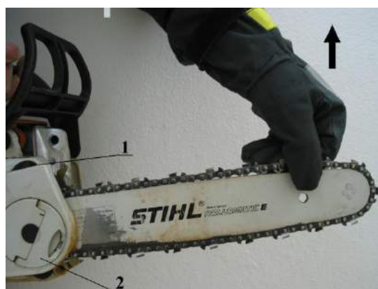
Fotografia nr 5.4. Prawidłowe napięcie łańcucha tnącego
