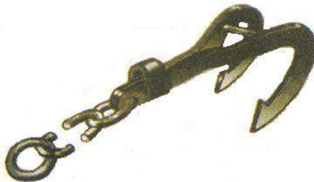
Fotografia nr 3.19. Kotwica pożarnicza 48
