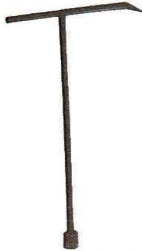
Fotografia nr 5.24 Klucz do stojaka hydrantowego 61
