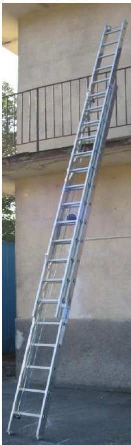
Fotografia nr 4.8. Drabina wysuwana typ 2×18 S
