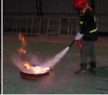
Fotografia nr 3.35. Gaszenie cieczy palnej gaśnicą śniegową
