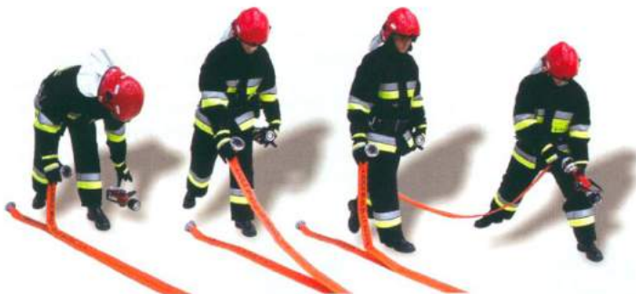
Fotografia nr 9.7 Łączenie węża z prądownicą 104
