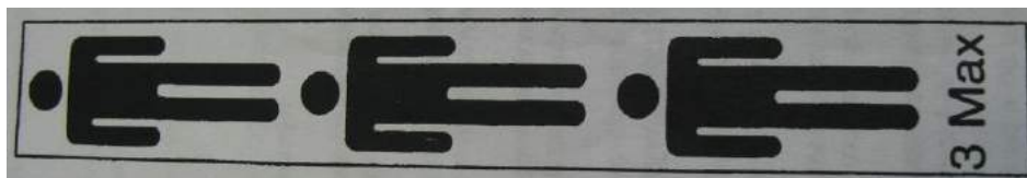
Fotografia nr 4.3 Oznaczenie drabiny trzyosobowej
