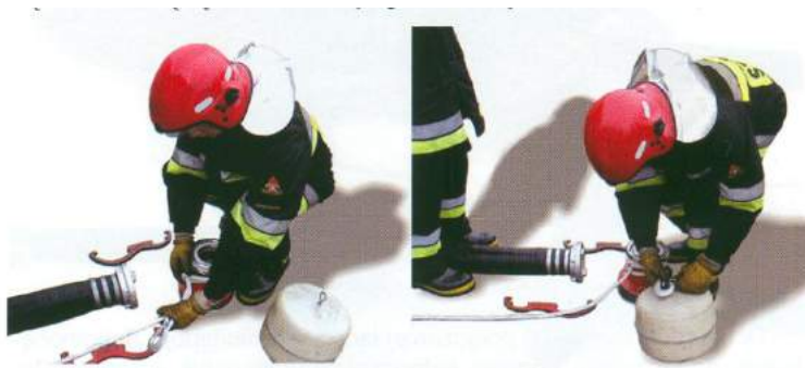
Fotografia nr 9.12. Zabezpieczenie smoka i pływaka linką ratowniczą 111
