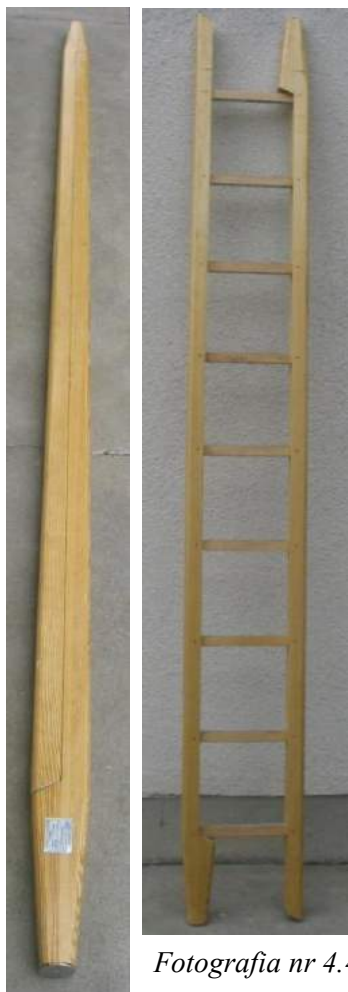
Fotografia nr 4.5. Drabina słupkowa w stanie złożonym
