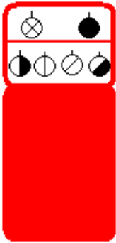
Rysunek nr 7.3. Wariant dla 6-osobowej załogi spotykany w samochodach z 6 – osobową kabiną np. w GBA 2,5/16, GBM3/8, GBAM2/8+8
