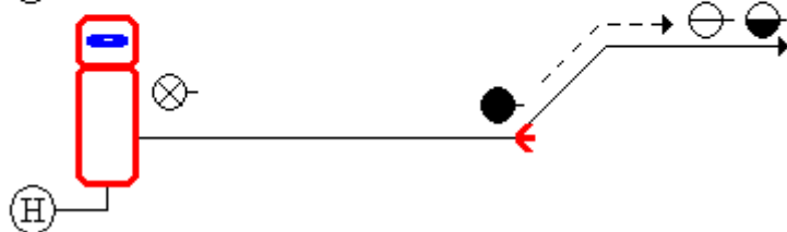
Rysunek nr 7.15. Rozwinięcie pełne podanie prądu gaśniczego
