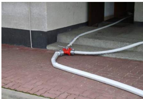
Fotografia nr 9.19. Ustawienie rozdzielacza przed wejściem do budynku
