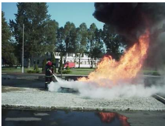
Fotografia nr 3.33. Gaszenie cieczy palnej gaśnicą proszkową
